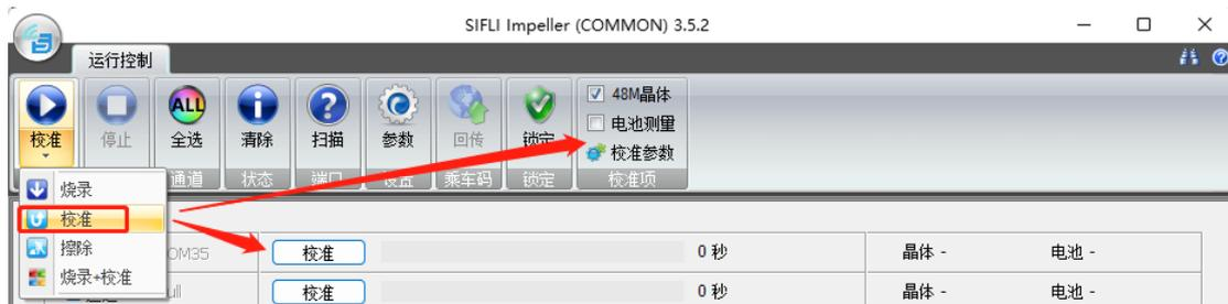
3) 根据需要勾选校准项目，点击校准项区域的参数设置，设置校准时的参数。正常情况下可以直接使用默认设置的参数，设置完参数后关闭该窗口。
