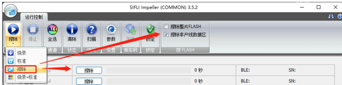
3) 根据需要勾选擦除的项目, 各通道会显示连接的设备端口号或者 JLINK 的 SN 号, 可以点击擦除按钮启动所有选择的通道擦除, 或者点击各通道运行控制按钮启动擦除功能。擦除过程中可以通过点击停止按钮停止所有通道擦除, 或者点击单个通道的停止按钮停止对应通道。
